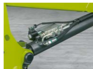
Гидроаккумулятор в системе SHOCK ELIMINATOR позволяет минимизировать удары, колебания, сотрясения и вибрации.
