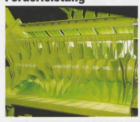
Die QUADRANT 2200 ist mit einem Förderrotor ausgerüstet, der aus 16 vierzackigen Sternen besteht. So werden die enormen Mengen Erntegut, die von der 2,10 m breiten Pickup aufgenommen werden, sicher zur Preßkammer weitergefördert.
