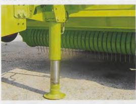
300 mm Bodenfreiheit genügen, um alle Unebenheiten zu überfahren, ohne die Pickup zu beschädigen.
