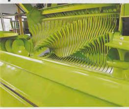
Die seitlichen Schnecken für den Einzug der Pickup haben einen großen Durchmesser (250 mm), um eine optimale Förderung des Erntegutes zur Mitte der Presse zu erzielen. Die ideal gewählte Drehzahl (288 Umdrehungen/min) ergibt maximale Erntegutförderung ohne Verstopfung.
