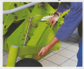
Die Tasträder bestimmen die Arbeitshöhe der Pickup. Je nach Stoppelhöhe und Erntegut kann eine unterschiedliche Einstellung gewünscht werden. 10 verschiedene Arbeitshöhen können einfach über eine Lochleiste eingestellt werden.
