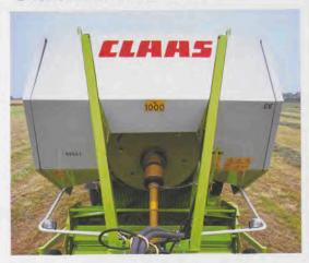
Das Chassis der **QUADRANT**-Pressen ist robust und großzügig konzipiert, so daß alle mechanischen Elemente problemlos zugänglich sind.
