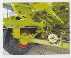
Die Presse **QUADRANT 2200 RC** kann mit einer gefederten Tandemachse für Fahrgeschwindigkeiten bis zu 60 km/h ausgestattet werden (geltende StVO beachten). (62 km/h mit ABS-Sonderausrüstung)
