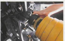
Eine robuste und waagerecht verlaufende Weitwinkelgelenkwelle erlaubt mehr Leistung ohne die Gefahr von Vibrationen. Diese optimierte Anordnung bewirkt einen runden Lauf auch in engen Kurven auf kleinen Parzellen. Diese Gelenkwelle hat entscheidend weniger Schmiermittelbedarf. Der Schnellverschluß ermöglicht komfortables Einhand-Ankuppeln.
