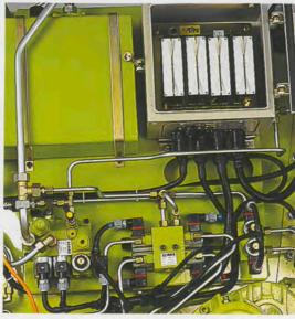
Alle wesentlichen Bauelemente des Hydraulikkreislaufes sind auf einer Platte angeordnet. Der Hydraulikkreislauf wird durch einen zentralen Öltank versorgt.
