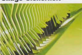
Durch die Abstreifer wird eine vollständige Reinigung des Förderrotors erreicht. Die 51 Abstreifer greifen in die Rotorzinken und reinigen dort den Rotorkörper direkt. So wird vermieden, daß Erntegut in die Pickup zurückgeführt wird.
