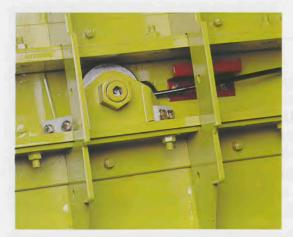
Der Kolben der **QUADRANT 2200** verdient besondere Aufmerksamkeit. Er bewegt sich auf einer vernieteten Rollenbahn. So ist sein Lauf besonders eben und gleichmäßig. Neu entwickelte Kolbenlager sind die Basis für maximale Lebensdauer. Mit größerem Durchmesser und einer neuartigen Abdichtung wird die Zuverlässigkeit der Kolbenlager wesentlich erhöht.
