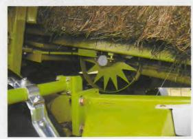
Das Sternrad ist im unteren Teil des Preßkanals angebracht und dient zur Überwachung der Ballenlänge. Da es nicht durch die Kolbenschläge beeinflußt wird, kann die Ballenlänge genau gemessen werden.
