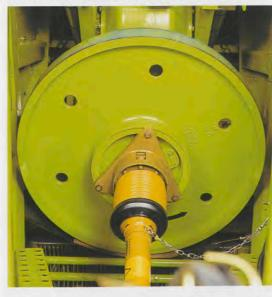
Die Schwungmasse der **QUADRANT 2200** ist im Vergleich zu den Vorgängermodellen im Außenbereich 40 kg schwerer geworden. Dies bringt einen Kraftgewinn von 50 %. Auf diese Weise wird ein ruhiger Lauf sichergestellt, und Belastungsspitzen können wirksam abgebaut werden.
