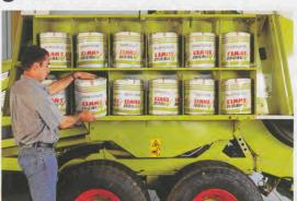
Der Garnkasten nimmt 24 Rollen Garn auf, so daß auch lange Arbeitstage ohne Stop durchgearbeitet werden können.
