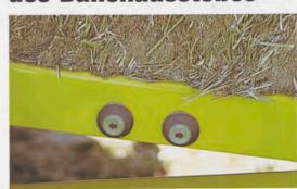
Der letzte Ballen, der gepreßt wurde, wird mit Hilfe des Ballenausstoßers abgelegt. Er wird durch Drücken eines Bedienungsknopfes auf der linken Maschinenseite in Gang gesetzt.
