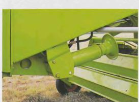
Der robuste Stützfuß mit hydraulischer Betätigung ermöglicht das Anheben der Deichsel auf die gewünschte Höhe. Die Bedienung vom Traktorsitz aus erlaubt eine schnelle und sichere Anhängung der Presse. Ein separates Ventil aktiviert nur den Stützfuß und verhindert somit jeglichen Bedienungsfehler.
