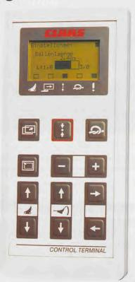
Die Ballenlänge kann bei der **QUADRANT** über das **CLAAS CONTROL TERMINAL** zwischen 1 m und 3 m variiert werden. Die einzelnen Schichten innerhalb des Ballens sind etwa 5 cm stark.
