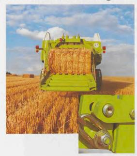
Die Ballen werden über die auf Wunsch lieferbare Rollenrutsche (bei QUADRANT 2200 RC Serie) nach Verlassen des Preßkanals sanft abgelegt. Anzahl und Anordung der Rollen sind so gewählt, daß der Ballen beim Ablegen auf den Boden nicht verformt wird.
