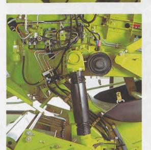
Die Getriebe für den Antrieb sind übersichtlich und klar angeordnet und aufeinander abgestimmt. Vom robusten Hauptgetriebe aus wird die Kraft zu den Förder- und Schneidaggregaten, den Bindeelementen und zu den Preßkolben weitergeleitet.
