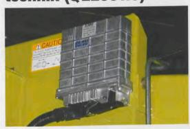
Die **QUADRANT 2200 RC** bietet mit der neuen CCU-Steuerungstechnik bereits alle Möglichkeiten der Kommunikation auf LBS-Basis. So können auch externe Terminals angeschlossen werden.
