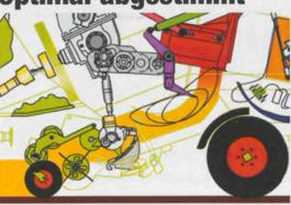
Der relativ kleine Pickup-Durchmesser (315 mm) gekoppelt mit einer hohen Drehzahl (127 Umdrehungen/min) ergibt die optimale Umfangsgeschwindigkeit (2,1 m/sec) für eine hohe Leistung der Presse.
