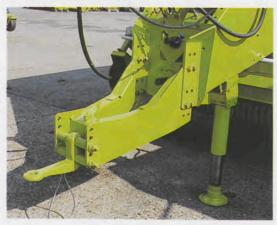
Die Großballenpressen **QUADRANT 2200** und **2200 RC** werden am Zugmaul oder im Zugpendel des Schleppers angehängt. Die Zugöse läßt sich in der Höhe an jeden Traktor anpassen.
