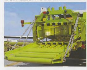
Mit Hilfe von drei Klappen, die durch Hubzylinder und einen Exzenter an der unteren Klappe eingestellt werden, erfolgt die Verdichtung des Erntegutes gleichzeitig von allen Seiten. Die Dichte kann dabei bequem in der Schlepperkabine vom CLAAS CONTROL TERMINAL verändert werden.
