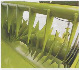
Der bei CLAAS eingesetzte Raffer mit 7 Zinken sorgt zusammen mit dem Förderoder Schneidrotor für den Guttransport von der Pickup in die Preßkammer (153 U/min). Dabei erfolgt der Transport in 3 Portionen pro Kolbenhub. Der lineare Hub des Raffers führt zur besonders gleichmäßigen Ballenform.
