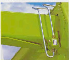
Die elektronische Kontrolle des hydraulischen Drucks stellt eine enorme Sicherheit dar. CLAAS geht noch einen Schritt weiter, um die Zuverlässigkeit zusätzlich zu erhöhen. Die QUADRANT ist mit einem Belastungsmesser am Preßrahmen ausgerüstet. So kann äußerst exakt das System gesteuert werden.
