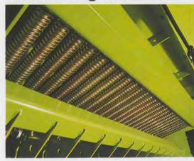
Die 25 Messer sind einzeln gesichert, falls ein Fremdkörper eingezogen wird. Dadurch wird vermieden, daß die Messer oder die Förderzinken beschädigt werden. Sobald der Fremdkörper keinen Schaden mehr anrichten kann, ziehen starke Federn die Messer automatisch wieder in die Arbeitsstellung zurück.
