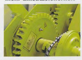
Die Knoter sind im Falle einer Überlastung gut gesichert. Sie werden durch einen Scherbolzen geschützt, der einfach zu wechseln ist und außerdem eine schnelle Re-Synchronisierung der Nadeln ermöglicht. Falls die Nadeln innerhalb des Preßkanals blockieren, wird ein Kontakt zwischen Nadeln und Preßkolben durch den "Kolben-Stop" verhindert.
