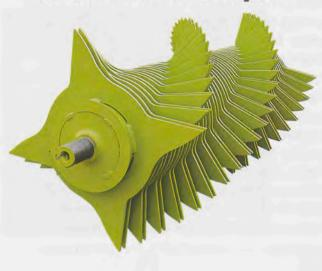
Hohes Schluckvermögen und ruhiger Lauf zeichnen die **QUADRANT 2200 RC** aus. Sie besitzt einen Sternrotor mit großem Durchmesser, der aus vierzackigen Sternen besteht. Auf diese Weise wird die hohe Schnittfrequenz - 560 Schnitte/min - und damit ein sauberer und schonender Schnitt mit gleichzeitiger Vorverdichtung erzielt.
