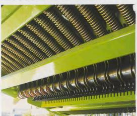
Drei Messer sind jeweils mit einer starken Feder gegen Fremdkörper abgesichert. Dieser Schutz verhindert Schäden an den Messer und den Förderorganen.
