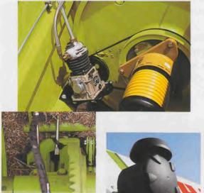
Die Druckluft-Knoterreinigung ist der Garant für höchste Einsatzsicherheit. Abhängig von der Durchsatzmenge wird zweimal zwischen einem Knotervorgang gereinigt.
