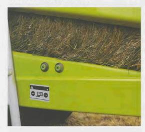
Mehr Preßdichte, aber weniger Verstopfung in den Preßkanalecken.
