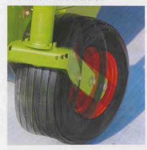
Die Pickup der QUADRANT 2200 ist mit zwei großdimensionierten Tasträdern ausgerüstet.
