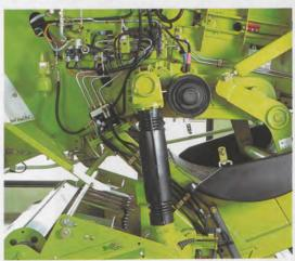
Zuverlässigkeit durch eine "intelligente" Folgeschaltung für alle CLAAS-Kunden, die ihre **QUADRANT** bis an die Kapazitätsgrenze auslasten. Diese Überlastungssicherung für den Raffer, bestehend aus einer modernen, automatischen Überlastkupplung, ist direkt mit der Überlastsicherung des Schneidwerks und der Pickup verbunden.
