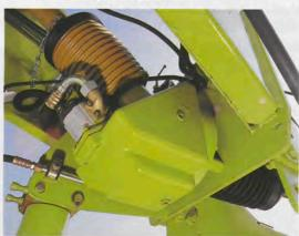
Ein spezielles Eingangsgetriebe an der Zugdeichsel ermöglicht, daß die Gelenkwelle vom Schlepper und die Gelenkwelle zum Hauptgetriebe unter optimaler geradliniger Anordnung laufen. Dieses Eingangsgetriebe gibt es nur bei CLAAS. Die Erschütterungen werden minimiert, und die Zuverlässigkeit der gesamten Maschine wird erhöht.
