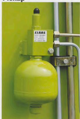
Die Pickup der **QUADRANT 2200** ist mit einer hydraulischen Entlastung ausgerüstet. Die Tasträder werden so gleichmäßig entlastet, so daß die Pickup ruhiger läuft und den Boden nicht belastet. Eine im Hydrauliksystem integrierte Stickstoffblase sorgt dafür, daß die Pickup nahezu über den Boden schwebt. Die Tasträder führen schonend über alle Bodenunebenheiten. Die Pickup wird sicher vor Schäden geschützt.
