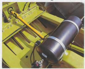
Der Antrieb der Knoter erfolgt direkt vom Hauptgetriebe über eine Gelenkwelle und ein Zahnrad. So ist eine perfekte Synchronisierung des Kolbens mit den Nadeln gewährleistet.
