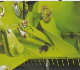
CLAAS bietet als Standardausrüstung die hydraulische Aushebung der Pickup an. Das heißt: Bedienungskomfort erster Klasse. Zwei direkt an der Pickup angeordnete Hydraulikzylinder bewirken einen schnellen Aushub.
