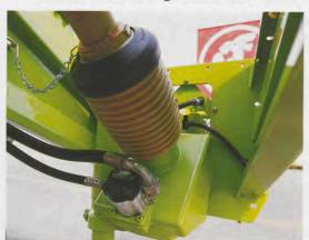
Schmutzpartikel im Hydraulikkreislauf sind ein Problem, vor dem jeder schon einmal stand. Um dieses Problem zu vermeiden, wurde die CLASS QUADRANT mit einer schlepperunabhängigen, bordeigenen Hydraulik ausgestattet.
