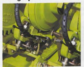
Mit der zentralen Schmierung können automatisch oder manuell, entsprechend der gewünschten Ausstattung, bis zu 45 Stellen an der QUADRANT 2200 geschmiert werden.
