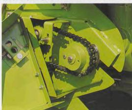
Die Sicherung der Pickup und der seitlichen Schnecken gegen Überlastung - die in diesem Bereich nur äußerst selten vorkommt - erfolgt mittels einer 8-mm-Scherschraube mit 10.9 Qualität.
