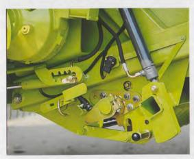
Das Wechseln der Schnittlänge ist mit dem ROTO-CUT-Schneidwerk kein Problem. Ohne Werkzeug oder umständliches Abmontieren einzelner Messer, nur durch Bedienung eines Hebels kann die Messeranzahl -
